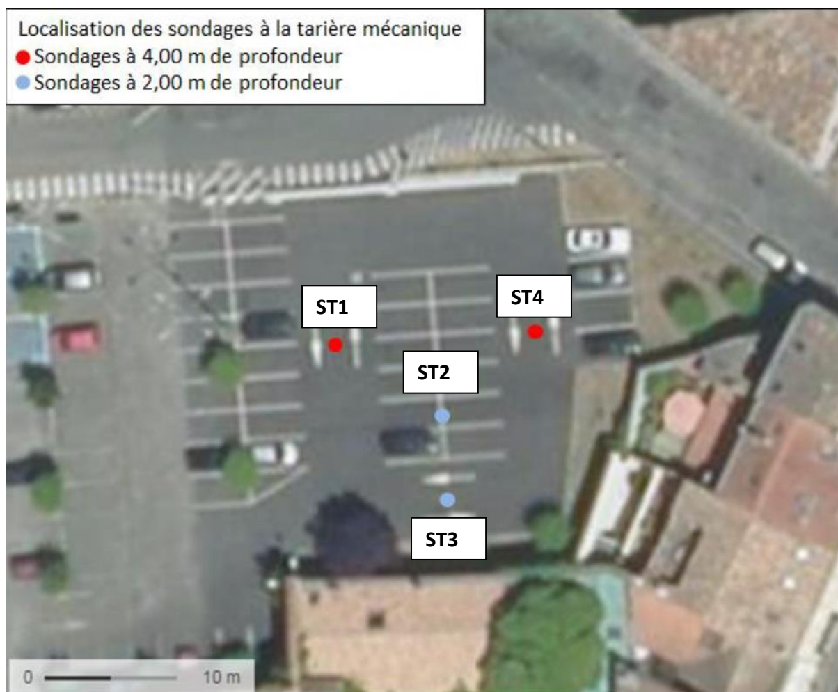
Figure 5 : Localisation des sondages à la tarière mécanique – (ECR Environnement septembre 2016)
